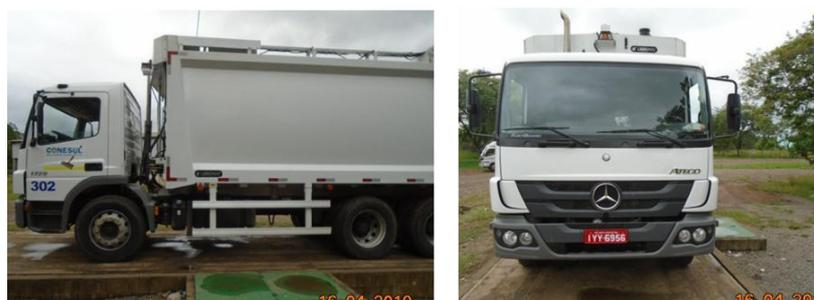
Figura 27: Caminhão prefixo 302, utilizado para coleta de resíduos de contêiner. Fonte: Conesul Soluções Ambientais.
